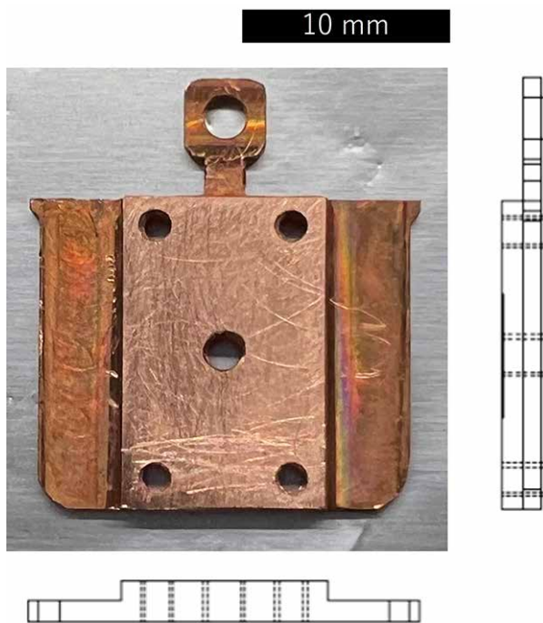
Figure 3. ユーザー実験に向けてJASRIが作成した試料プレートの一例。
