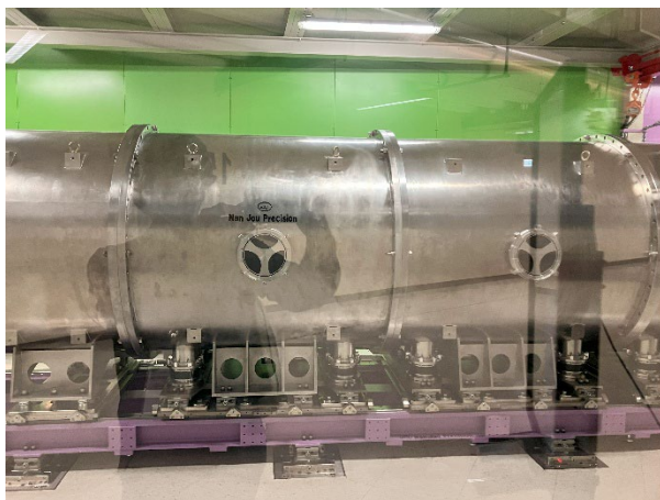
図3 TPS BL13Aの真空パイプ(報告者がガラス窓越しに撮影)。この中にSAXSとWAXS用の検出器が収められている。
