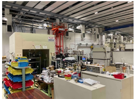
写真 5 BL43IR 外観。収納部天井から外壁 (赤色のラダー一部) を通り赤外光が取り出され、各ステーションに導かれている。
