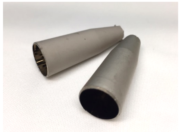
図 1 ナノ精度転写プロセスで作製された回転体ウォルターミラー。
