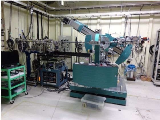
図4 BL13XU 実験ハッチ 1 に設置されている多目的6軸回折計。
