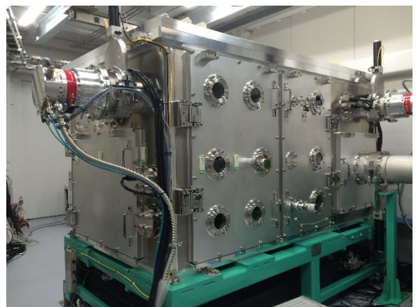
図 2 高エネルギー密度科学実験プラットフォーム。XFEL とハイパワーフェムト秒レーザーの同時利用実験が可能である。大型の真空チャンバーを基礎とする装置が実験ハッチ (BL2 EH6) に常設されている。
