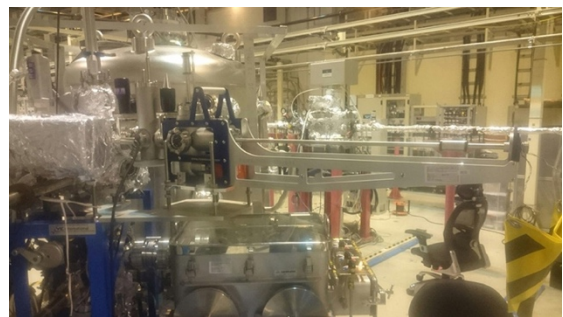
図2 SPring-8の光電子ホログラフィー装置DIANAに取り付けたUHVスーツケース。
