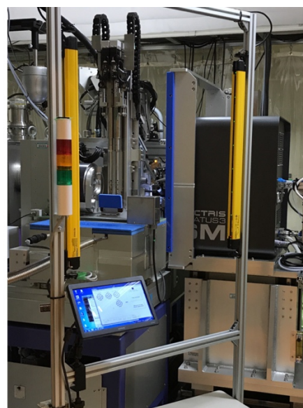
図2 BL45XUに設置された回折計 (左: 試料周辺環境、右: 装置へのアクセス部)
