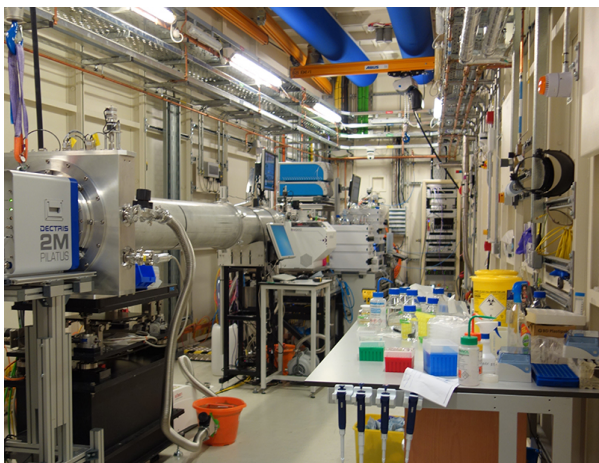
図2 B21 の実験ハッチ。手前側に検出器、奥側に HPLC やオートサンプラーがある。
