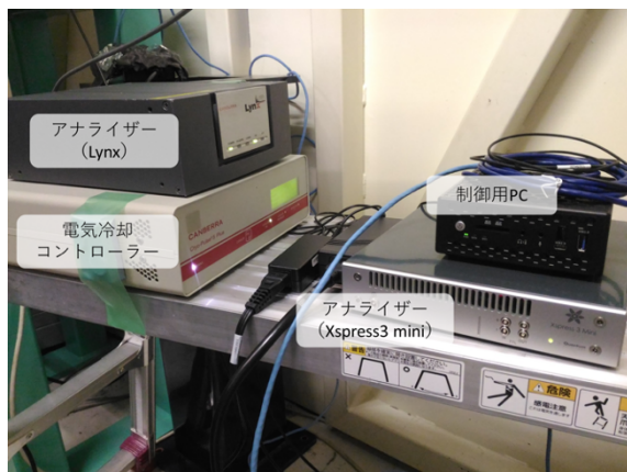
図3 アナライザーなどの設置状況
