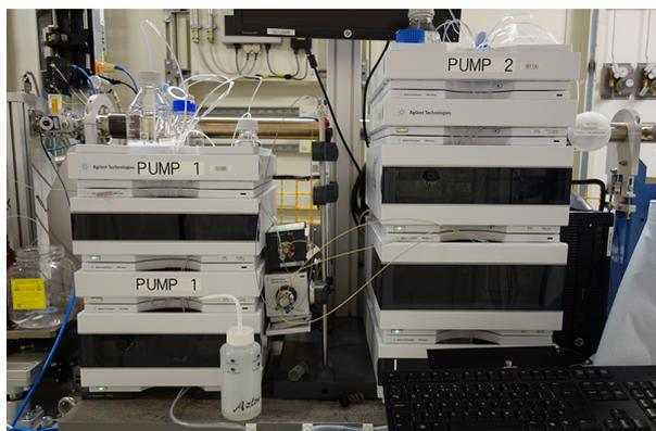
図4 SEC-SAXS で利用されている HPLC ポンプ。
