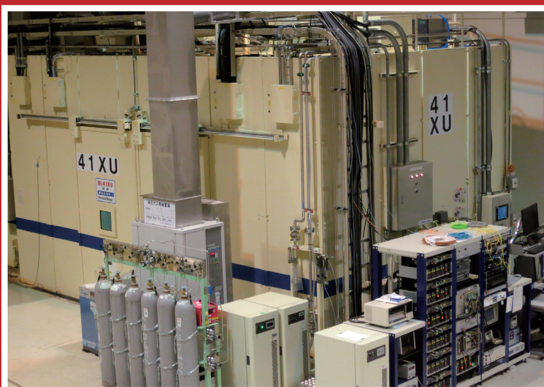
BL41XUの実験ハッチ2 新しい集光光学系・回折計・検出器が導入された
