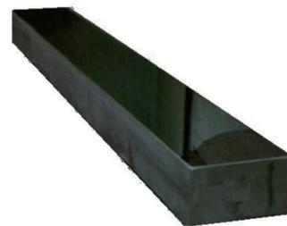
図1 長さ 400 mm の X線集光ミラー
