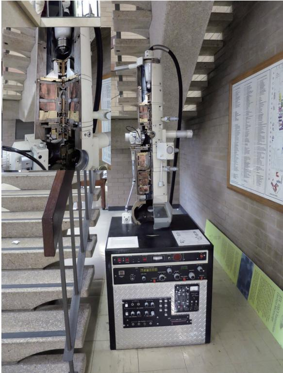
図4 1970年製の透過型電子顕微鏡 JEOL 100CX。どうやって切り取ったのか興味ある。
