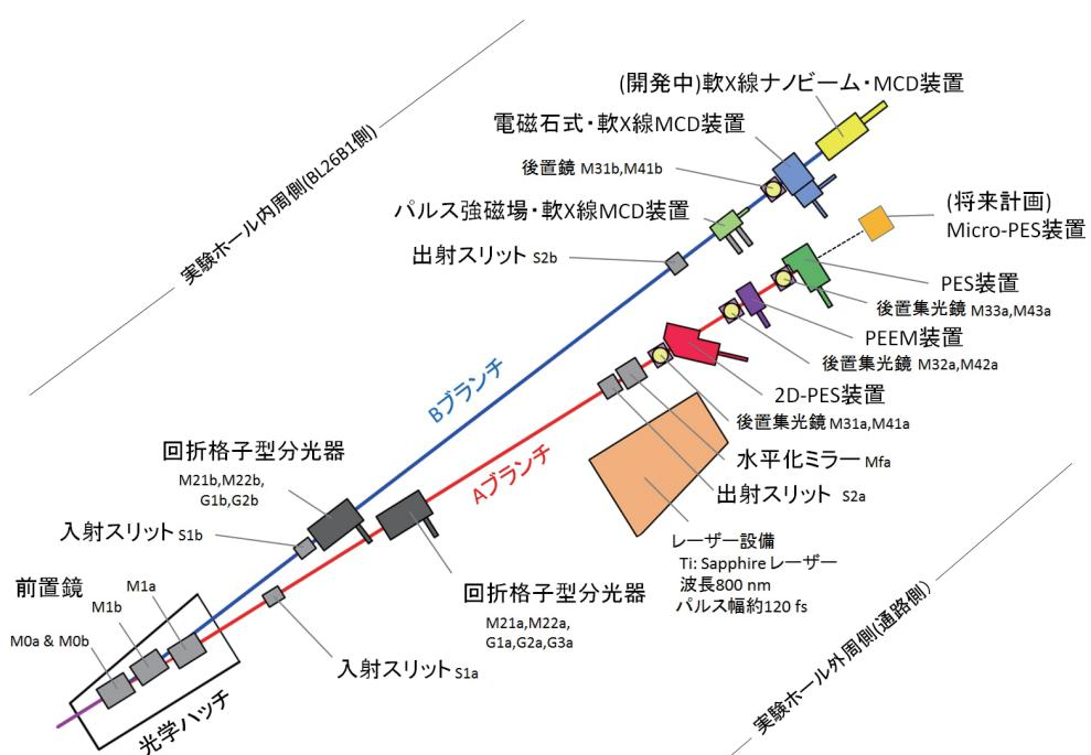
図1 改造後のBL25SUレイアウト。Mはミラー、Gは回折格子、Sはスリットを表す。各光学コンポーネントに添えた記号a, bは、それぞれA, Bブランチ用のコンポーネントであることを示す。
