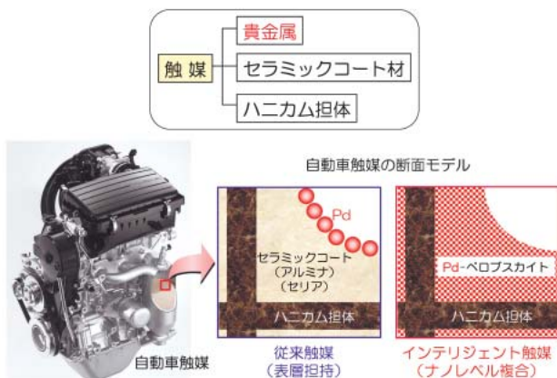
図1 自動車触媒の構成
