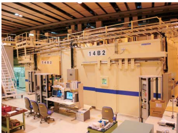
写真1 BL14B2の光学ハッチと実験ハッチ
