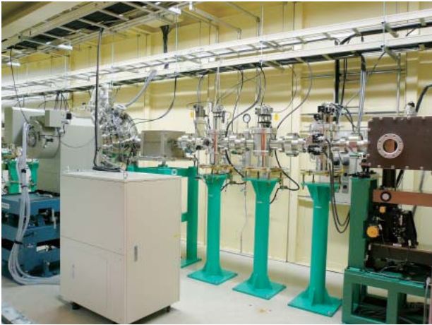
写真2 光学ハッチ内に設置された光学機器（モノクロメーター、ミラー等）
