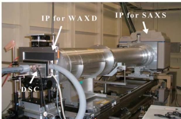
図4(a) 広角小角X線散乱ならびにDSC同時測定システム (BL402)
