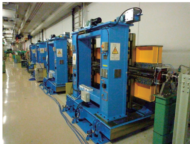
図2 直線部に設置された偏光制御型軟X線アンジュレーターの水平偏光部4台
