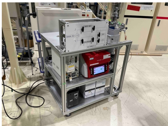
写真2 BL01B1 で利用可能な可搬式ガス分析装置。中段に四重極型質量分析装置、下段にマイクロガスクロマトグラフが固定されている。分析対象となるガス供給と排ガスのラインを繋ぐことで利用可能。
