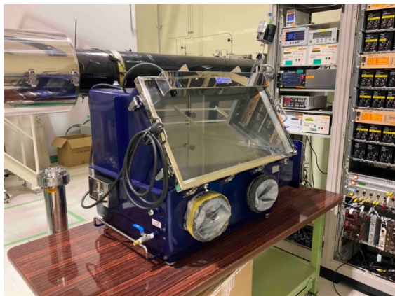
写真 4 BL09XU の試料準備用グローブボックス。循環精製装置を増設したのち、運用開始予定。
