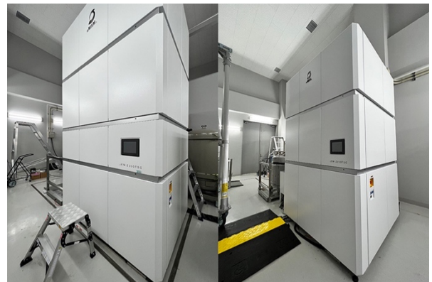
図 1 共用 CryoTEM 装置。(左)EM01CT: JEOL CRYO ARM 300 (JEM-Z300FSC)、(右) EM02CT: JEOL CRYO ARM 200 (JEM-Z200FSC)。
