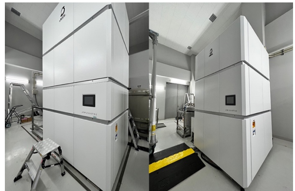
図 1 共用 CryoTEM 装置。(左)EM01CT: JEOL CRYO ARM 300 (JEM-Z300FSC)、(右) EM02CT: JEOL CRYO ARM 200 (JEM-Z200FSC)。
