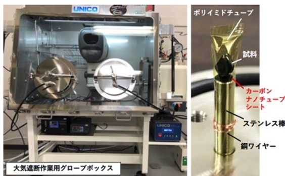
図6 大気遮断ホルダと大気遮断試料準備環境（高純度グローブボックス）。
