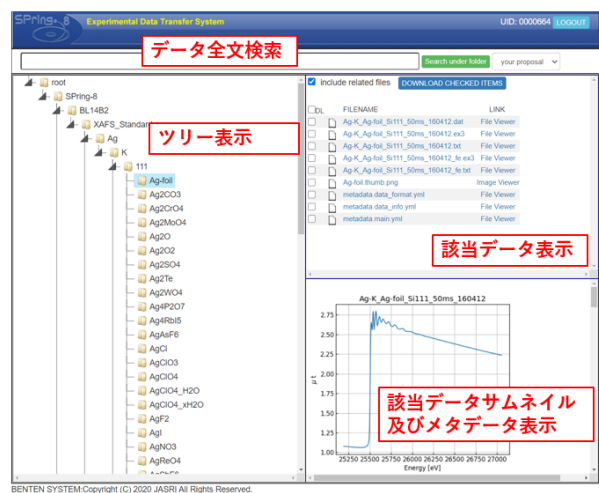
図 5 BENTEN Web ポータルにおける XAFS 標準試料のデータアクセス例
