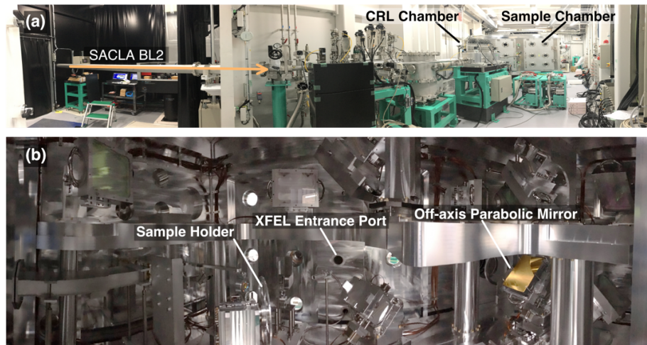
図1 (a) SACLA BL2 EH6 の概要。(b) 実験用真空チャンバーの内観。
