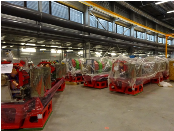
図 2 ESRF の拡張ホール内でインストールを待つアライメント済み磁石列。
