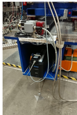
図 2 RIXS 分光器の極めて“シンプルな”散乱角の基準となるエンコーダー (写真中央部)。
