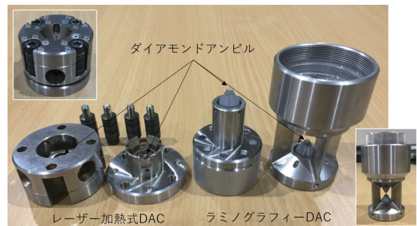
図 1 ダイヤモンドアンビル装置 (DAC)。目的に合わせて様々な型の DAC が開発されている。右は本研究で開発したラミノグラフィー撮像用ダイヤモンドアンビル装置。対抗する 1 対のダイヤモンドアンビルの間に試料を挟み加圧する。白枠が組立後（実験時）の様子。
