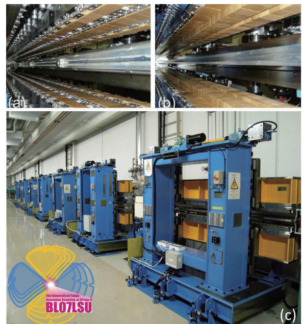
図1 SPring-8 BL07LSU の挿入光源 ID07 (a) 水平偏光型「8の字」アンジュレータ、(b) 垂直偏光型「8の字」アンジュレータ、(c) 2種類を各4台、合計8台のアンジュレータから構成された長尺アンジュレータの写真。挿入図はビームラインのロゴマーク。
