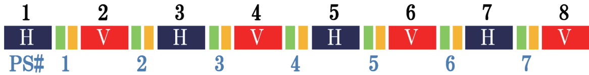
図2 SPring-8 BL07LSUの長尺アンジュレータID07の構成図。水平偏光型「8の字」アンジュレータセグメント (H) 及び垂直偏光型「8の字」アンジュレータセグメント (V) から構成され、それぞれの間に移相器 (PS) として「永久磁石型」(緑色) と「電磁石型」(黄色) がペアとなって設置されています (図3)。この図の右側にビームラインがあります。
