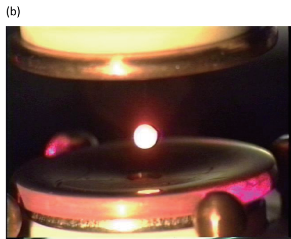
図2 (a) 静電浮遊溶解装置のシステム概要 (b) 静電浮遊法を用いて真空雰囲気 ( 10^{-5} Pa) で熔融されたホウ素。
