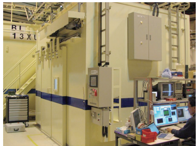
図 1 増設した第 4 実験ハッチの写真。
