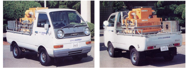
図2 アルカリ形燃料電池車：産総研1972年製 [5]
