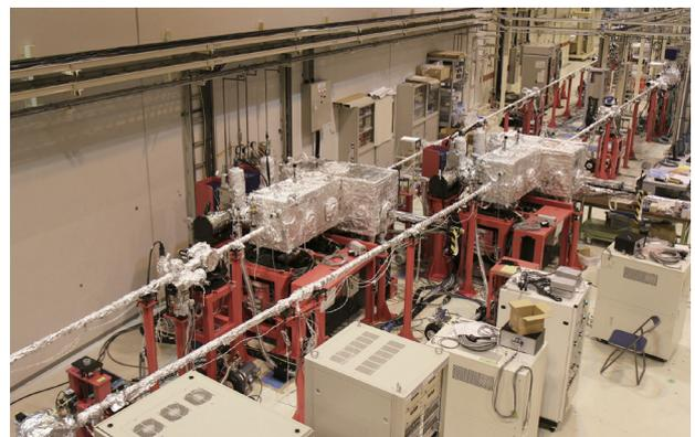
写真1 ナノビームブランチ(左)とマイクロビームブランチ(右)を有する改造後のBL25SUの様子。左下が上流に相当し、写真中央に位置する2台の装置は各ブランチ用の回折格子型分光器。
