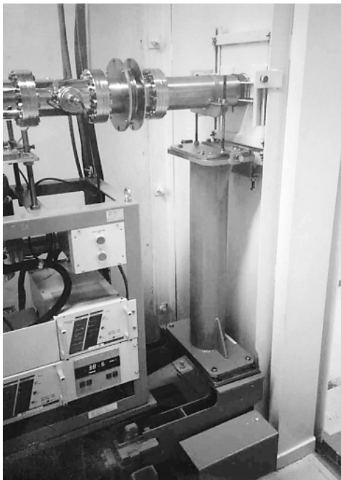
図2 傾斜架台(左)と光学ハッチと実験ハッチをつなぐ可動型ビームパス
