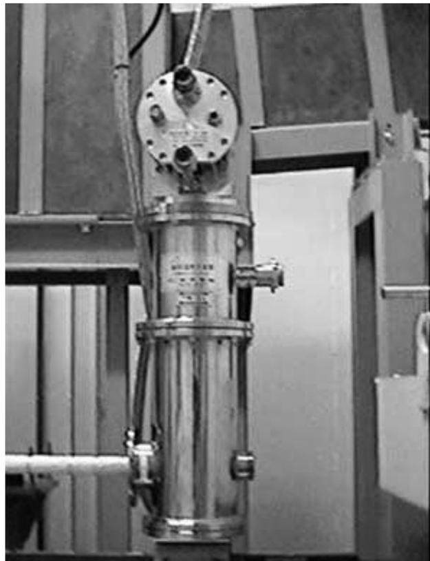
図4 試料用冷凍機
