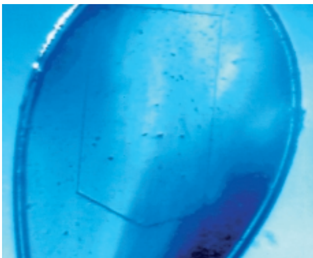
図1 実験室でナイロンループにすくい上げ、急速凍結した \text{Ca}^{2+} -ATPaseの板状結晶。BL41XUで回折実験の直前に撮影。結晶の幅は300 \mu\text{m} 、厚さは20 \mu\text{m} 程度。
