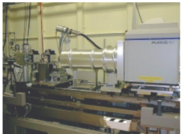
図5 BL40B2小角散乱装置設定
