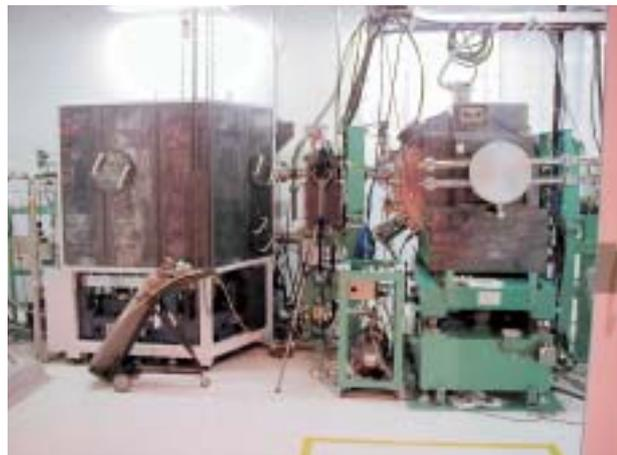
Fig. 6 二結晶分光器の設置状況
