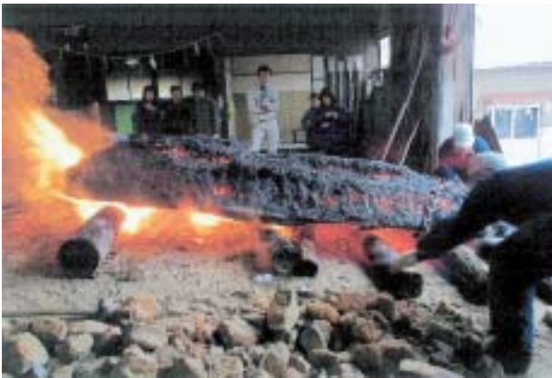
鋳出しの様子 一回の操業で12トンの木炭と、10トンの砂鉄が使われる
