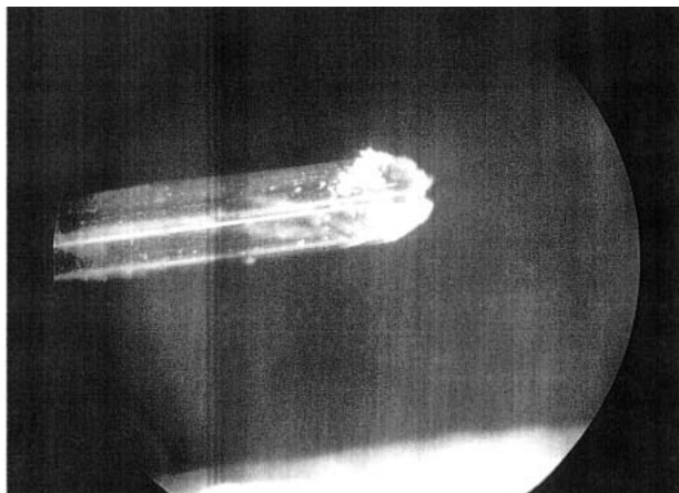
図16 キャピラリー(300ミクロン径)先端部分に付着した臭化ペクロニウムの状態
