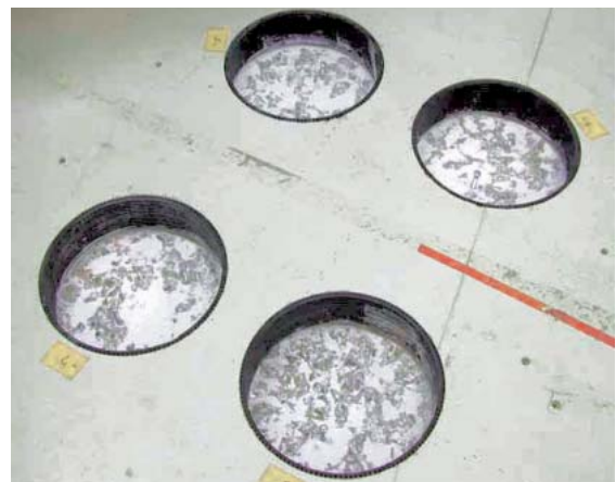
写真2-b 底面密着性向上とゴム取付
