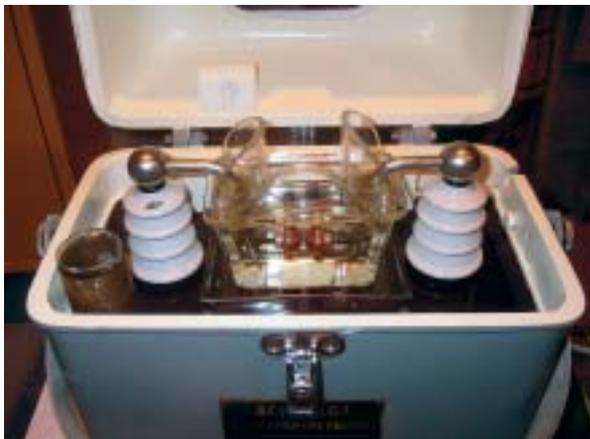
写真2 絶縁油試験装置
