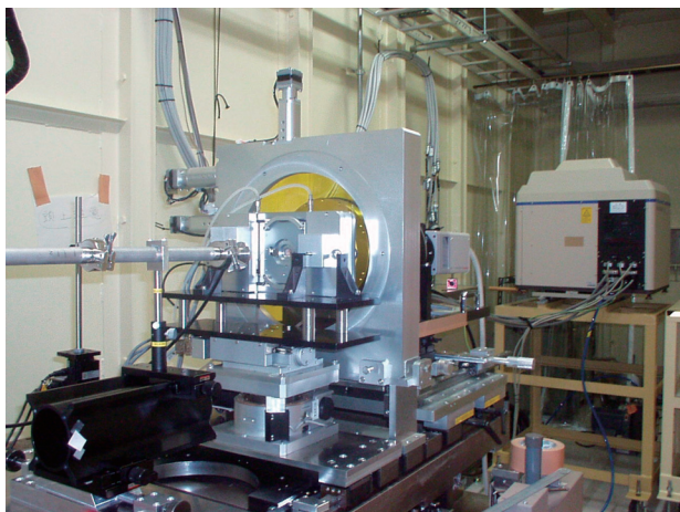
図2 流動セルを設置したBL40B2の広角散乱用セットアップ
