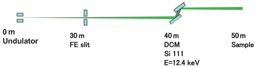
図4 モデルビームライン。光源はSPring-8標準型真空封止アンジュレータ。光源アンジュレータ1次光ピークエネルギーは12.4keV。分光結晶はSi(111)の平板型結晶としE=12.4keV。フロントエンドスリットサイズは0.5mm×0.5mmである。
