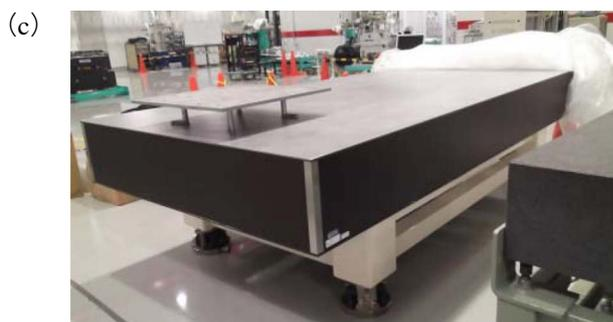
図2 (a) EH2の上面図。ハッチのサイズは7 m×7 m×高さ4 m。(b) 汎用可動式定盤、(c) 汎用光学定盤の一例。
