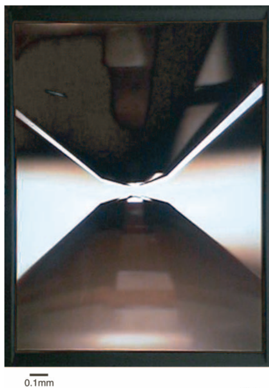
図1 超高压を発生するダイヤモンドアンビルの先端部。先端の直径は60ミクロン。
