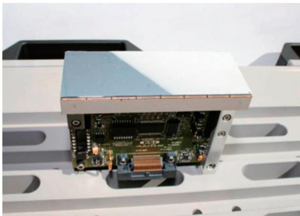
図1 PILATUSモジュール(ピクセルサイズ172  $\mu\text{m}$ 、受光面積83.8 mm $\times$ 33.5 mm、ピクセル数487 $\times$ 195)
