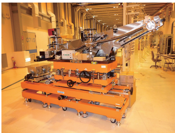
図7 超高分解能軟X線発光ステーション (HORNET)
