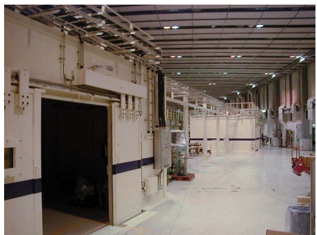
図3 BL36XU光学ハッチ (手前) と実験ハッチ
