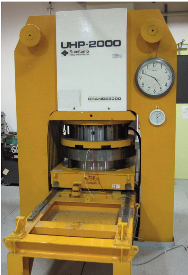
図2 Kawai型高圧合成装置 ORANGE-2000。
