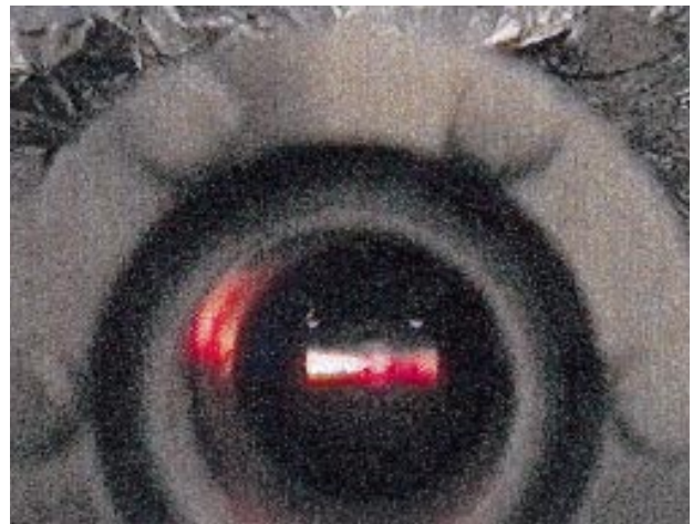
図1 スクリーンモニターで捉えた最初のアンジュレータ光（アンジュレータギャップ：50mm）。左右に拡がる偏向部放射（左：下流側偏向部、右：上流側偏向部）の谷間にアンジュレータ光が見える。
