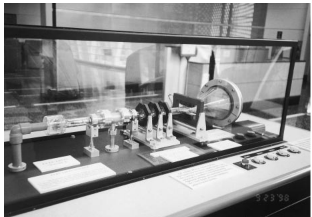
写真3 電子ビームモデル。APS Central Lab入り口には APSの説明パネルとともにこのモデルが展示してあり、電子銃や4極電磁石、偏向電磁石の働きを実感することができる。
