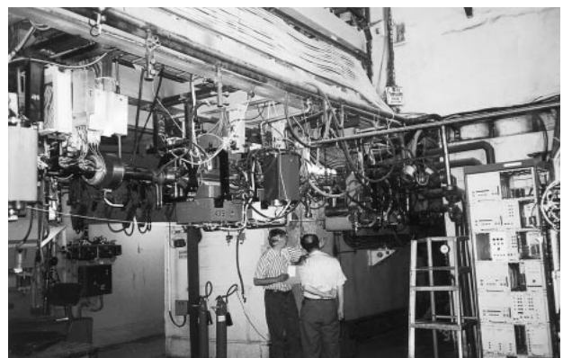
写真2 BINPの蓄積リングVEPP-3の偏向電磁石。この加速器は常識に反して(?)天井に取り付けてあり下からの加速器へのAccessibilityがよい。
